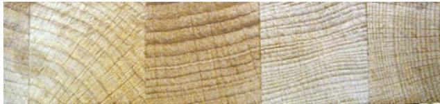
Les différentes règles parfaitement calibrées sont ensuite collées parallèlement sous pression. On note que l'orientation du bois est différente dans chaque lamelle, ce qui permet de donner à la planche une résistance égale dans toutes les directions de l'espace. Notons de plus l'importance de la qualité de la colle utilisée.
