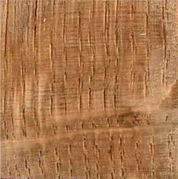
Coupe longitudinale radiale de bois de chêne. Les gros vaisseaux verticaux du bois de printemps des différents cernes apparaissent nettement. Ils sont discontinus car la section n'est pas parfaitement longitudinale. Les rayons du bois apparaissent sous forme de stries perpendiculaires aux vaisseaux (champs de croisement).
