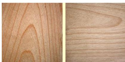
*Deux portions de feuilles tangentielles obtenues placées selon des directions perpendiculaires. La direction longitudinale est verticale à gauche et horizontale à droite.*
