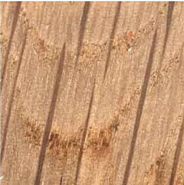
Le bois a été mouillé. Les rayons sont sectionnés perpendiculairement à la direction de leurs éléments ; ils apparaissent foncés. Le reste de la coupe constitué de vaisseaux et fibres longitudinaux apparaît plus clair. La coupe n'étant pas parfaitement longitudinale, le bois de printemps de deux cernes (gros vaisseaux) apparaît sous forme d'arceaux plus foncés. Ce type de section est prisée car elle donne des effets décoratifs très intéressants (planches, placages, marquetterie).
