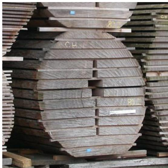
La fabrication de plateau de table peut difficilement se réaliser à partir d'une seule planche (sauf exception). L'association de plusieurs planches ou plusieurs tasseaux orientés de manière adéquate permet, de plus, de compenser les problèmes de voilage.
