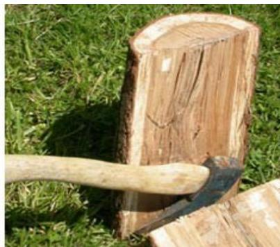
Le bois est un matériau anisotrope. Sa résistance est très forte dans le sens longitudinal et peut se fendre aisément dans le sens radial.
