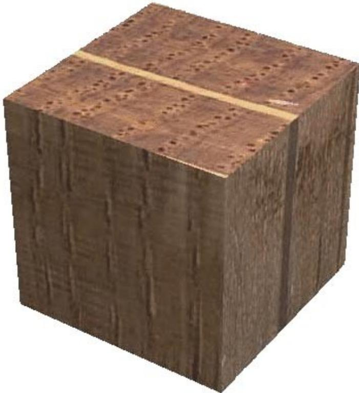
*Reconstitution tridimensionnelle d'un cube de bois de chêne de 1 cm de côté réalisé à partir des macrophotographies des 3 types de sections d'un même échantillon (transversale en haut, radiale à gauche et tangentielle à droite).*
